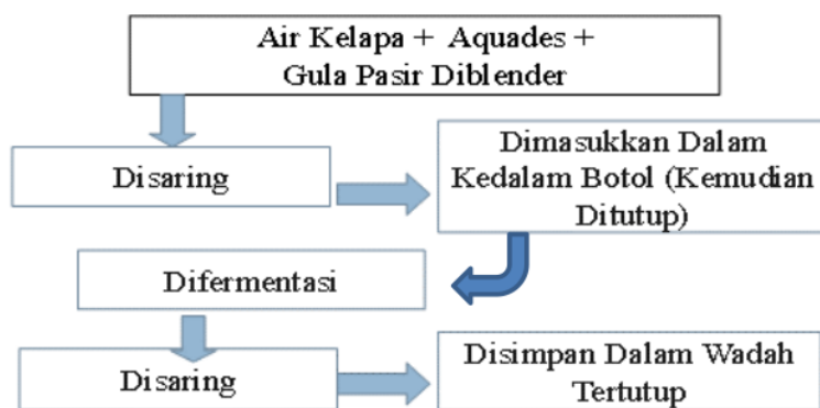
Gambar 1 Tahapan Proses Ekstraksi Air Kelapa
